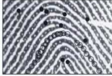
Şekil 2.9. Uç ve çatallar (içi dolu daireler) ve iç-tepeler (içi boş daireler)
